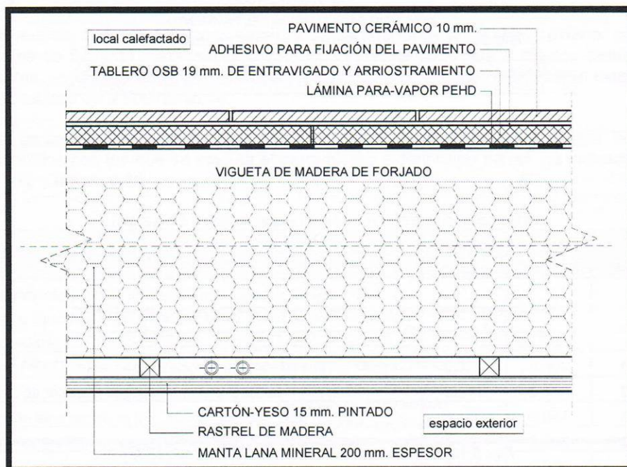
Fig. 5.9. Forjado tipo en vuelo sobre espacio exterior (S2)
