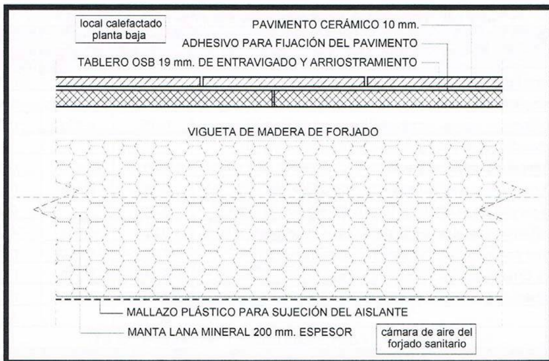
Fig. 5.8. Forjado sanitario tipo (S1)
